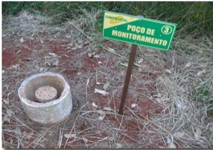
**Figura 10.13 -Aterro Sanitário da empresa CONTINENTAL em Xanxere - Poço piezométrico**
