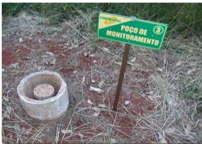
Figura 11.10.-Aterro Sanitário da empresa CONTINENTAL na cidade de Xanxere – SC – Poço piezométrico
