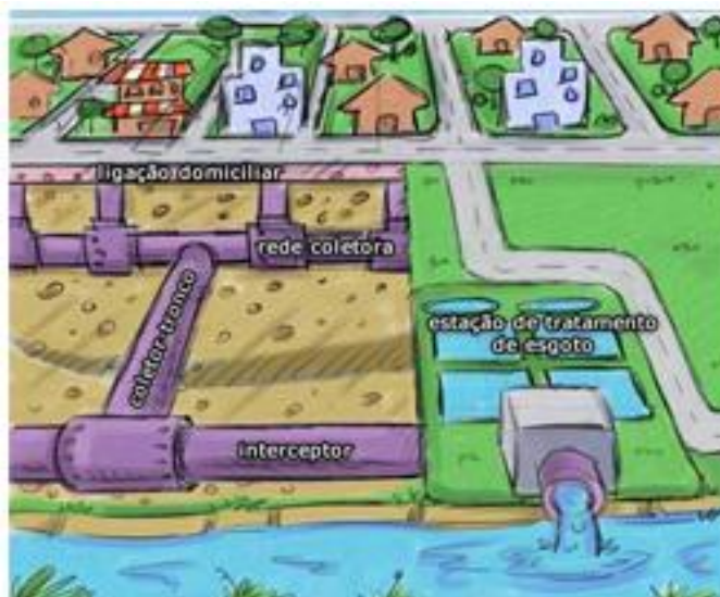
Figura 3 – Sistema de Esgotamento Sanitário
