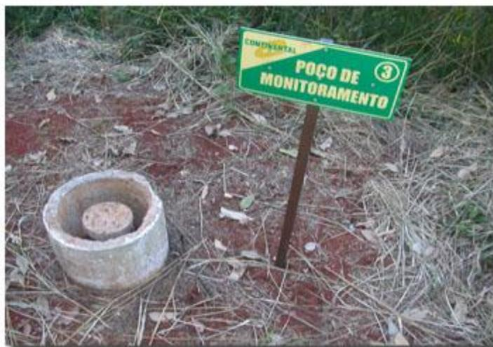
**Figura 11.12 -Aterro Sanitário da empresa CONTINENTAL na cidade de Xanxerê – SC – Poço piezométrico**
