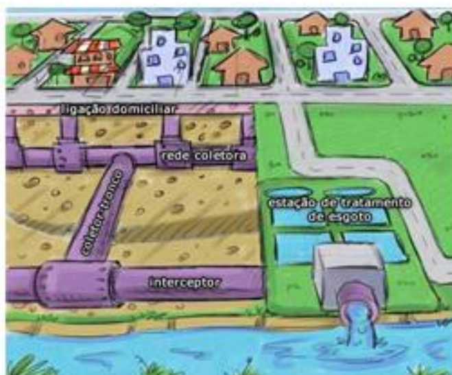
Figura 3 – Sistema de Esgotamento Sanitário
