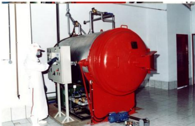
Figura 11.12. -Autoclave empresa TUCANO Obras e Serviços Ltda FONTE: Tucano Obras e Serviços Ltda.
