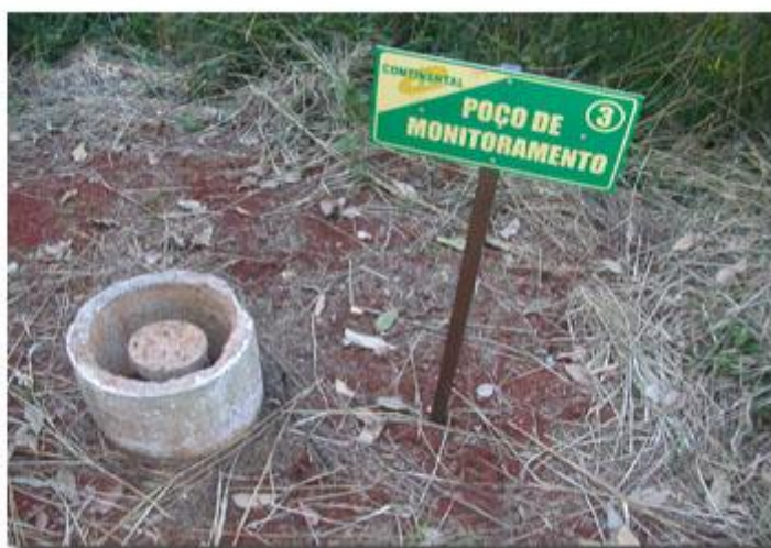
Figura 10.12.-Aterro Sanitário da empresa CONTINENTAL na cidade de Xanxerê – SC – Poço piezométrico
