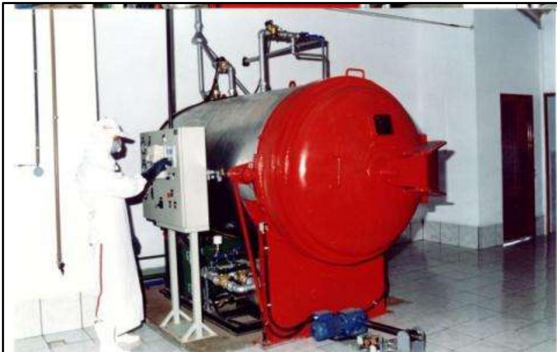
Figura 17: Autoclave empresa TUCANO Obras e Serviços Ltda.
