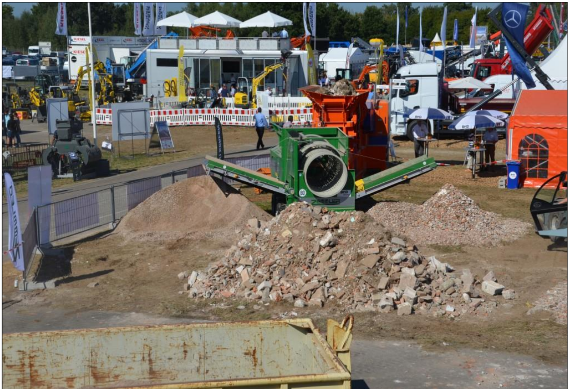
Figura 17 - Tecnologia móvel para tratamento e reaproveitamento dos resíduos da construção e demolição civil RCD
