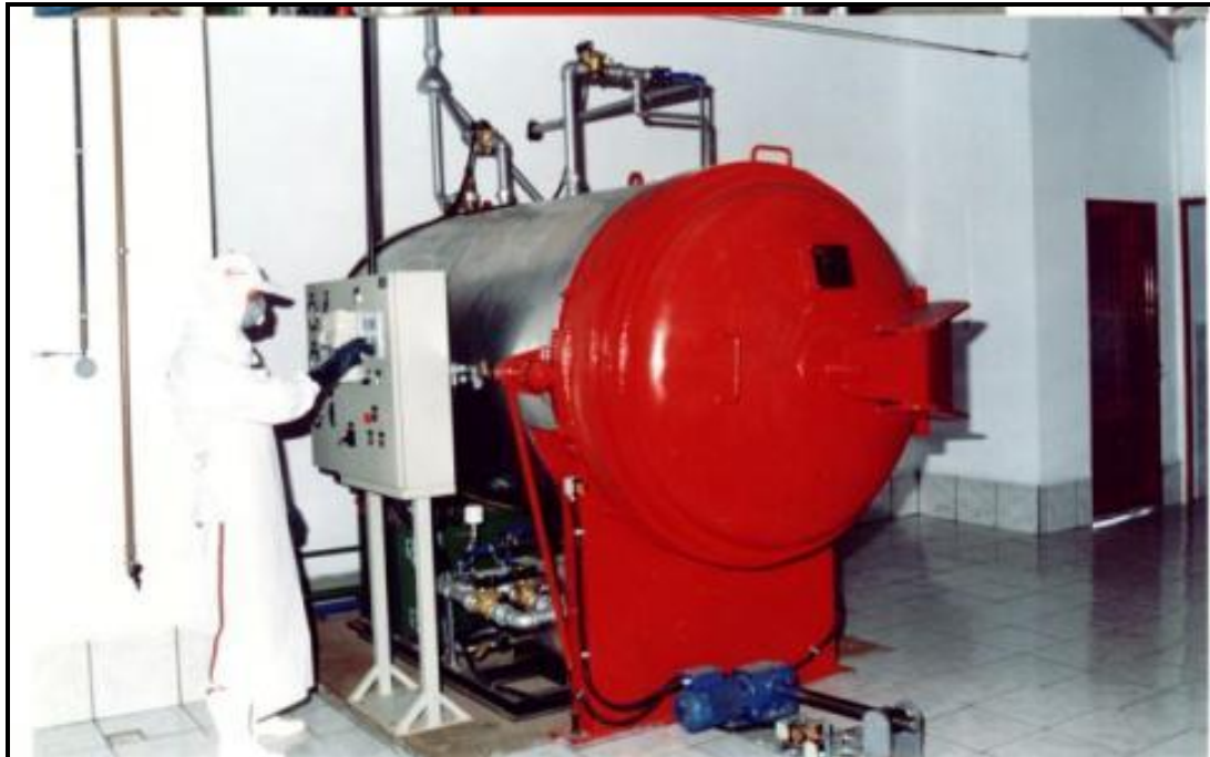
Figura 9: Autoclave empresa TUCANO Obras e Serviços Ltda Unidade I -Saudades-SC
